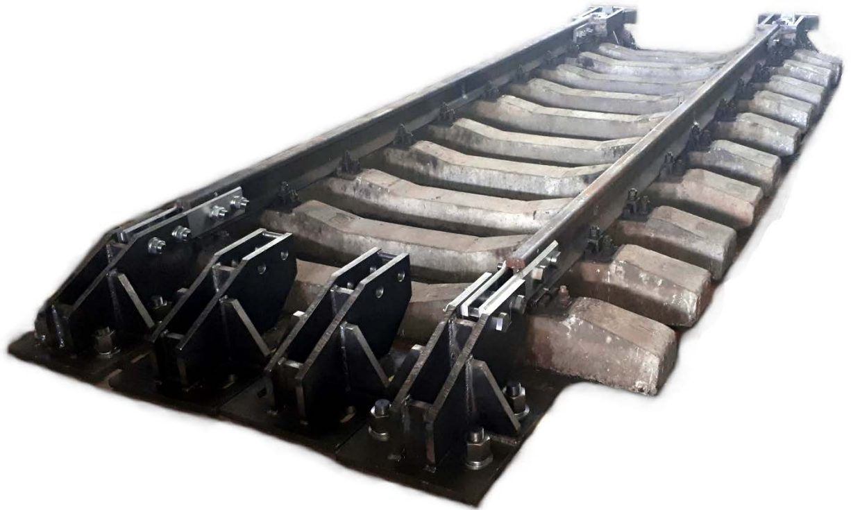
Рисунок 13 – Стенд для испытаний рельсошпальных решеток (вид сверху)
