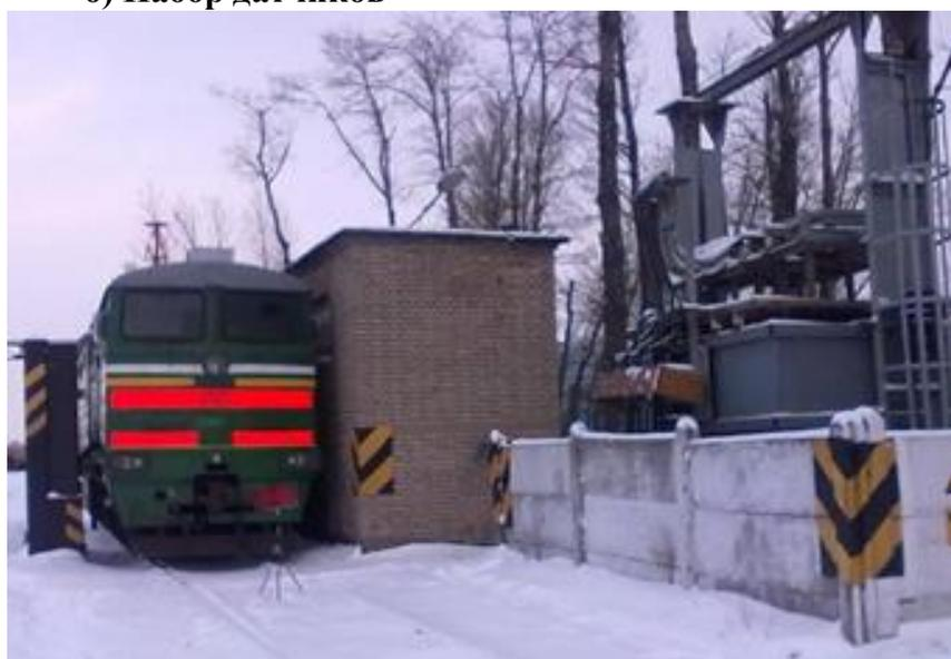
**д) Тепловоз на реостатных испытаниях**
