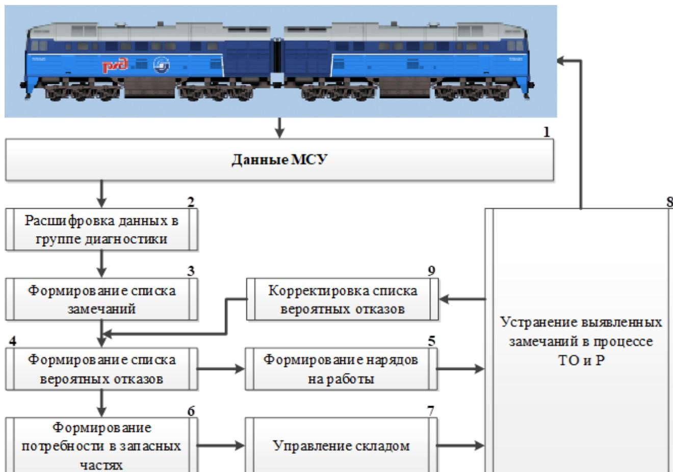
Рисунок 3.1 – Предлагаемый алгоритм использования данных МСУ в диагностике
