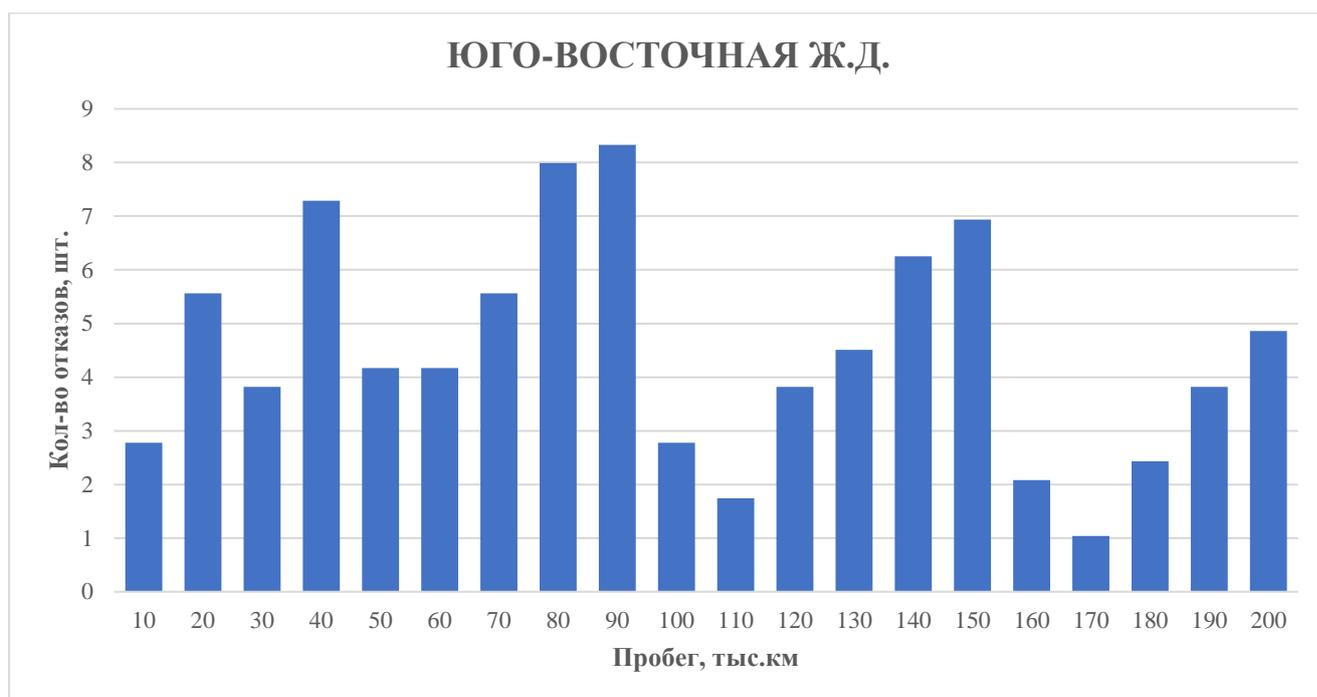
**Рисунок 1.8 – Подробный анализ среднего количества отказов на секцию тепловоза в зависимости от пробега после ремонта объёма «ТР-3» по Юго-Восточной железной дороге**
