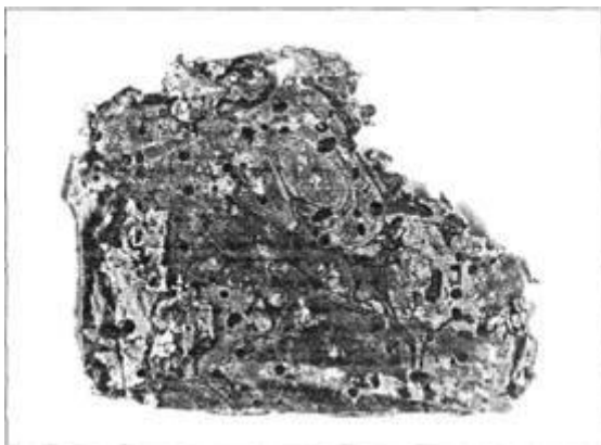
Рис. 5.10. Части переплетов, поврежденные хлебными точильщиками
