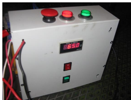
Рисунок 3.2 – Принципиальная схема – а) и общий вид – б) устройства обнаружения пробоя (УОП)
