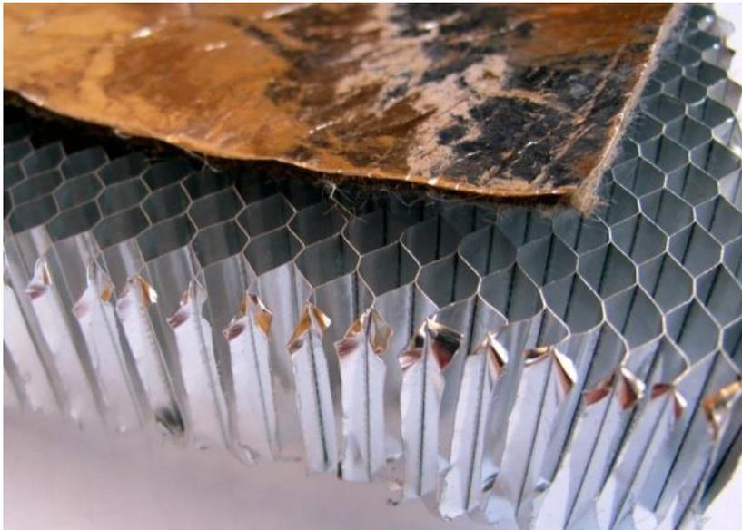
Рисунок 5.8- Дублированный материал НО-Л-1А, размещенный на алюминиевом сотовом наполнителе
