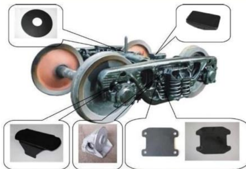
Рисунок 1.5 - Тележка модели типа 18-100 (ЦНИИ-ХЗ) (с подшипниками качения и модернизацией по проекту М 1698)
