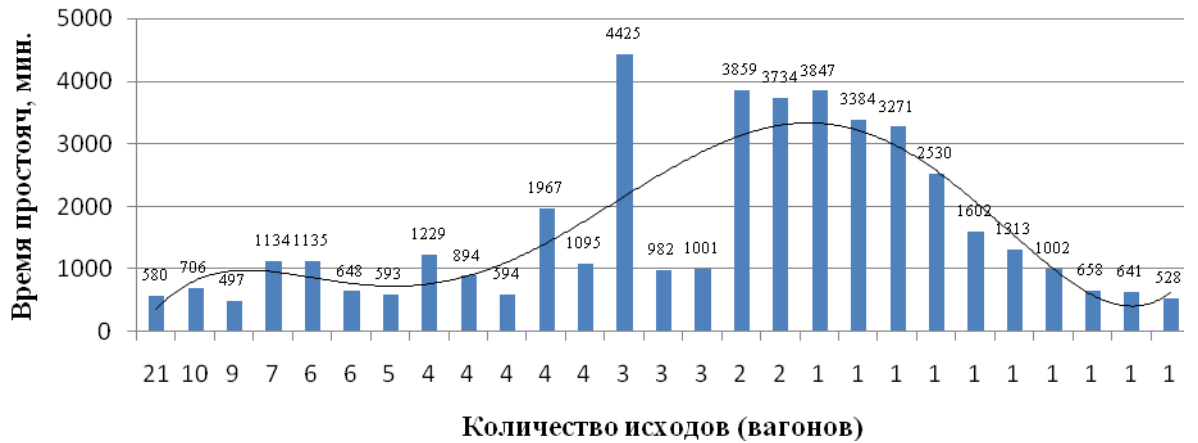
Рис. 2.17 Гистограмма простоя вагонов с коксом от прибытия до подачи в порт, мин
