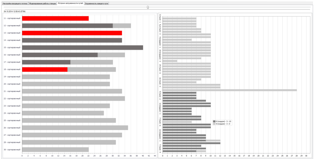
Рис. 2.28 Модельное изображение загруженности путей станции и причалов морского порта при поступлении восьми поездов (в т.ч. шесть фидерных поездов) на припортовую станцию
