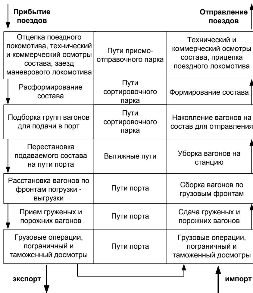
Рис. 2.11. Технологическая схема обработки экспортного и импортного вагонопотоков
