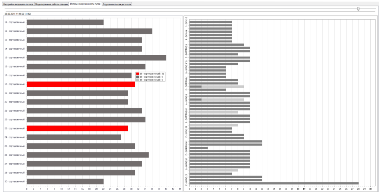
Рис. 2.25 Модельное изображение загруженности путей станции и причалов морского порта при поступлении шести поездов в систему
