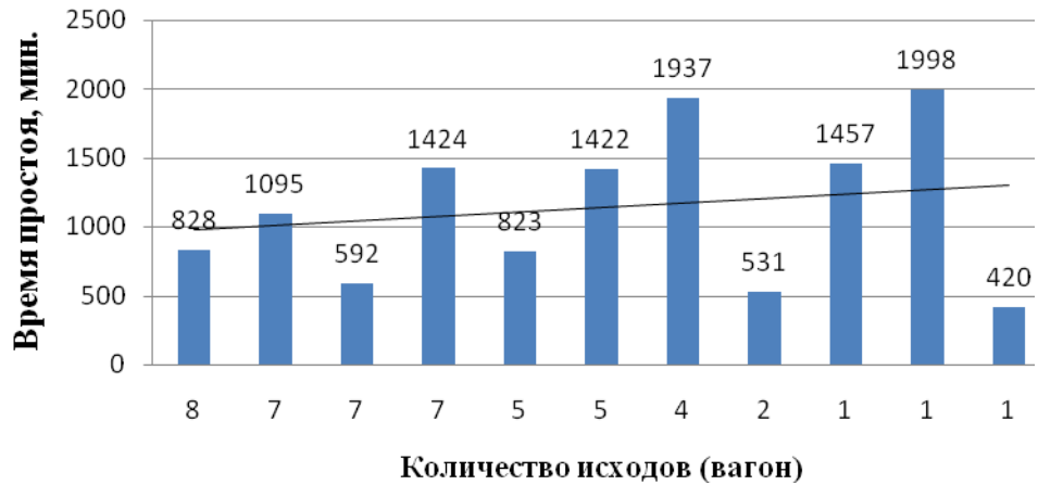
Рис. 2.13 Гистограмма простоя вагонов с диз. топливом от прибытия до подачи в порт, мин
