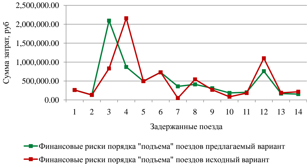
Рисунок 4.6- Сравнение величины финансовых рисков при изменении порядка «поднятия» задержанных в продвижении поездов.
