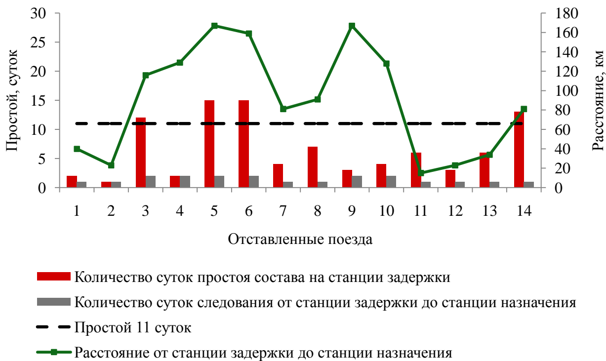
Рисунок 4.5- Предлагаемая последовательность «поднятия» отставленных от движения поездов, следующих назначением на станцию Новокуйбышевская.
