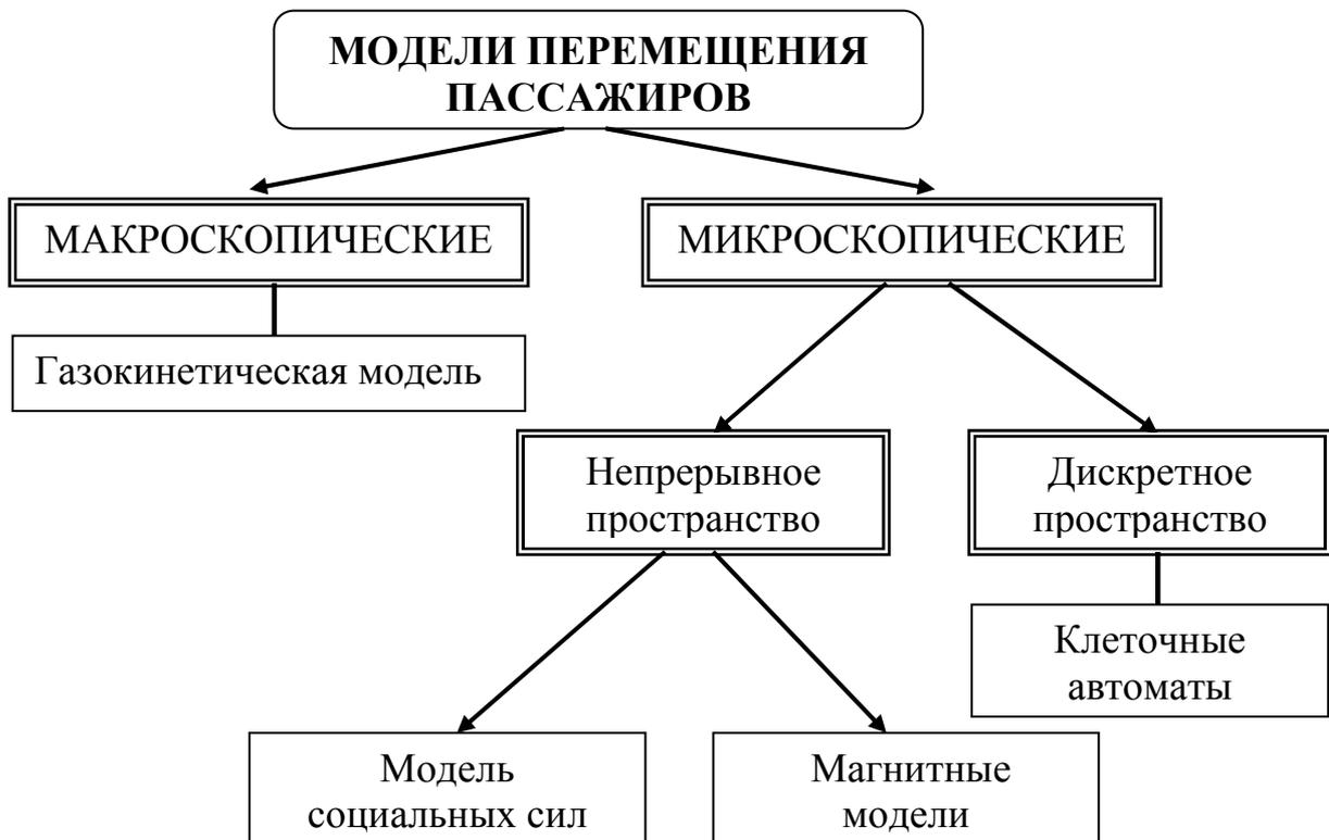
Рисунок 3.1 – Структура множества моделей, применяемых при моделировании пассажиропотоков
