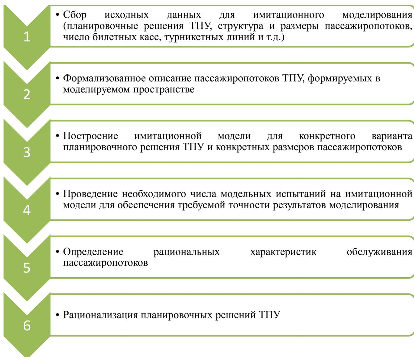
Рисунок 3.11 – Этапность процесса моделирования пассажиропотоков в ТПУ
