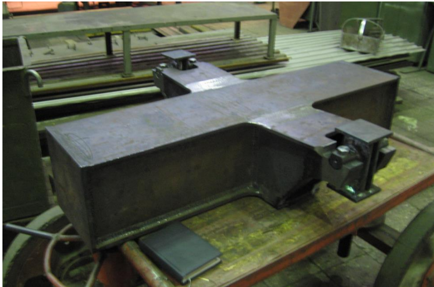
Рисунок 4.9 – Образец для испытаний (с новыми кронштейнами редуктора)
