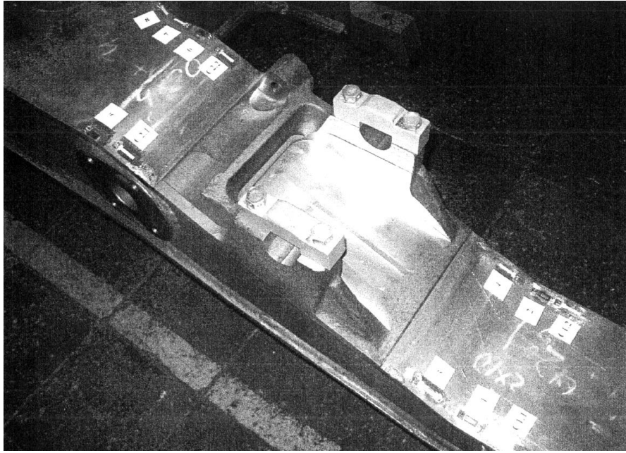
Рисунок 4.3 – Тензодатчики в зоне кронштейна крепления рычага буксы
