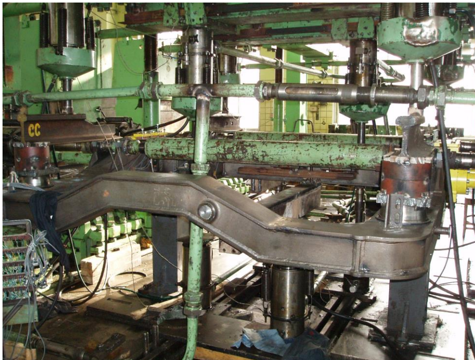
Рисунок 4.4 – Опытная рама тележки на стенде ВНИИЖТ
