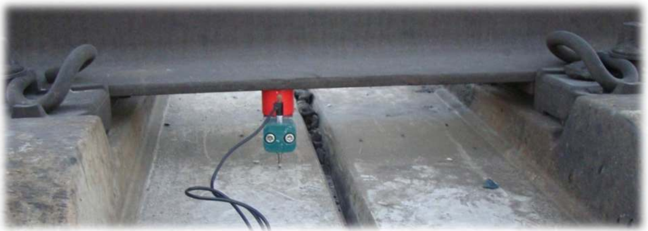
Рисунок 3.19 – Датчик перемещения между рельсом и плитой
