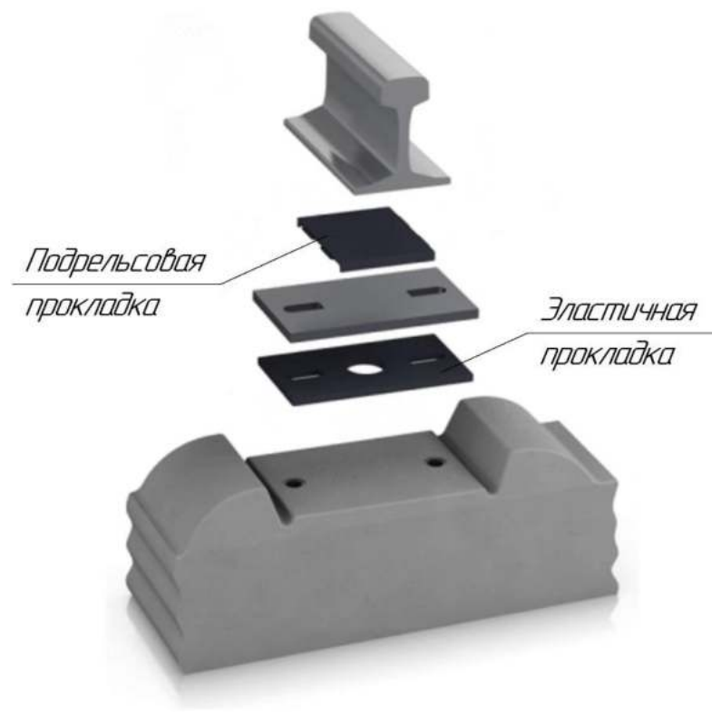
Рисунок 2.11 – Схематическое изображение прокладок в узле крепления
