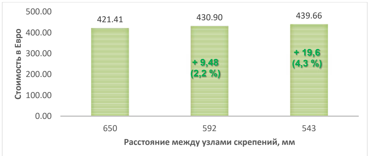
Рисунок 3.28 – Прогнозируемые затраты стоимости вышедших элементов скрепления на участках БВСП за период 1 млрд. т брутто пропущенного груза
