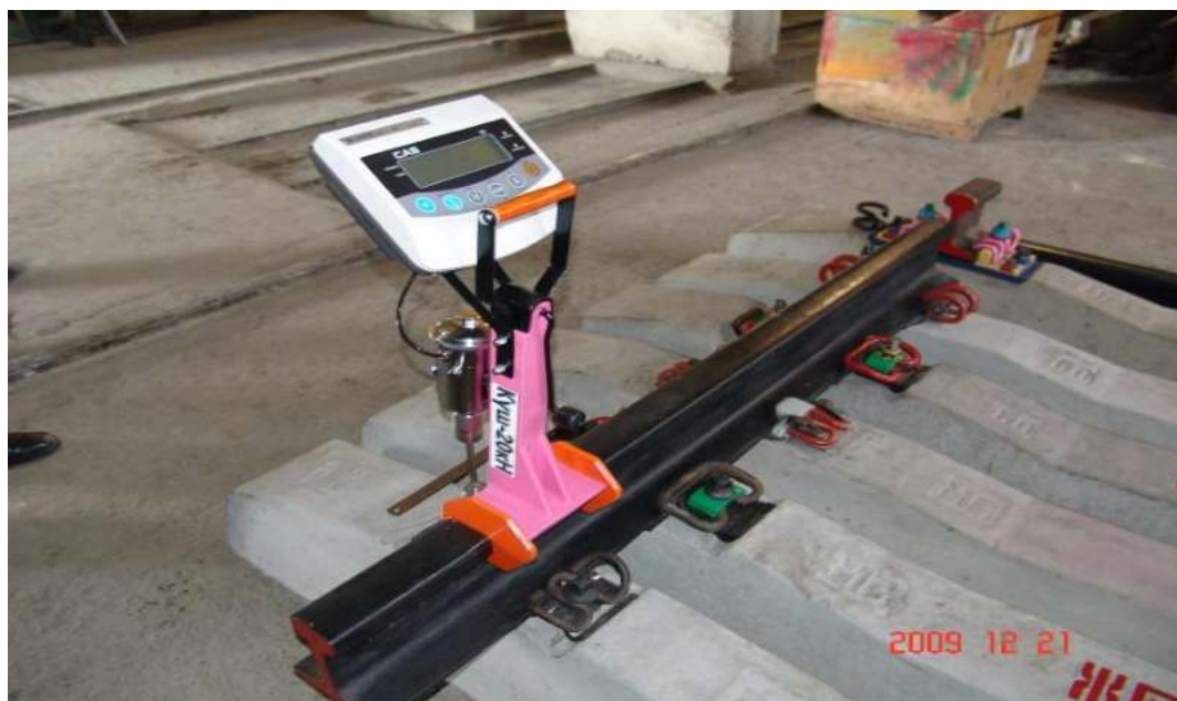
Рисунок 1.17 – Универсальный прибор для измерения усилия прижатия упругих клемм «Күш-20кН»
