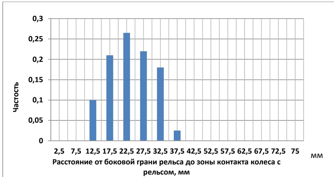
Рисунок 4.15 – Распределение поперечных перемещений колесной пары в рельсовой колее от внутренней боковой поверхности рельса
