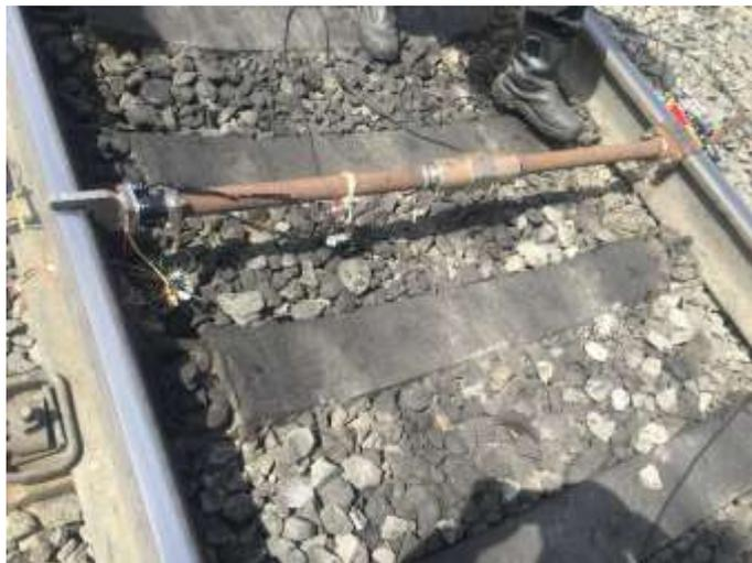
Рисунок 3.22 – Общий вид винтовой тяги для создания поперечного нагружения рельсов
