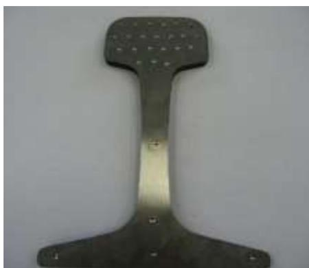
Рисунок 4.6 – Темплет рельса с вмятинами от шарика для определения твердости по поперечному сечению рельса
