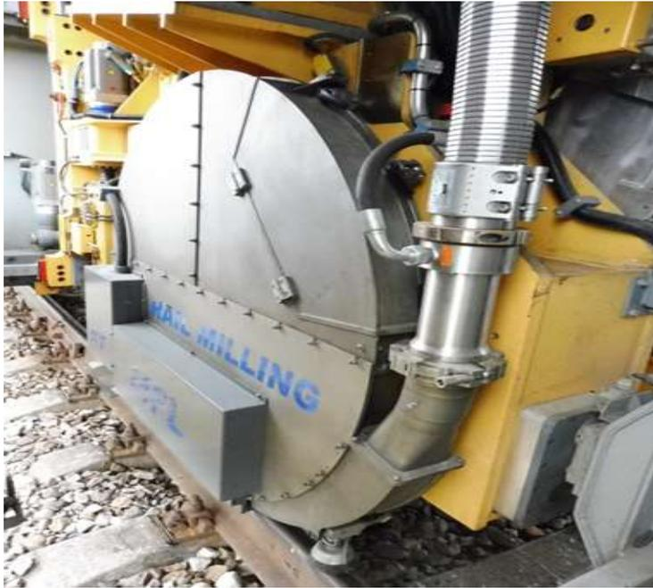
Рисунок 7.2– Общий вид рабочих органов РФП-1- фрезерных колес
