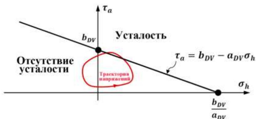
Рисунок 1.9 – Графическое представление критерия усталости Данг Вана в состоянии отказа, показывающее, что путь нагружения и напряжения образца пересекает линию критерия во время цикла нагружения [76]
