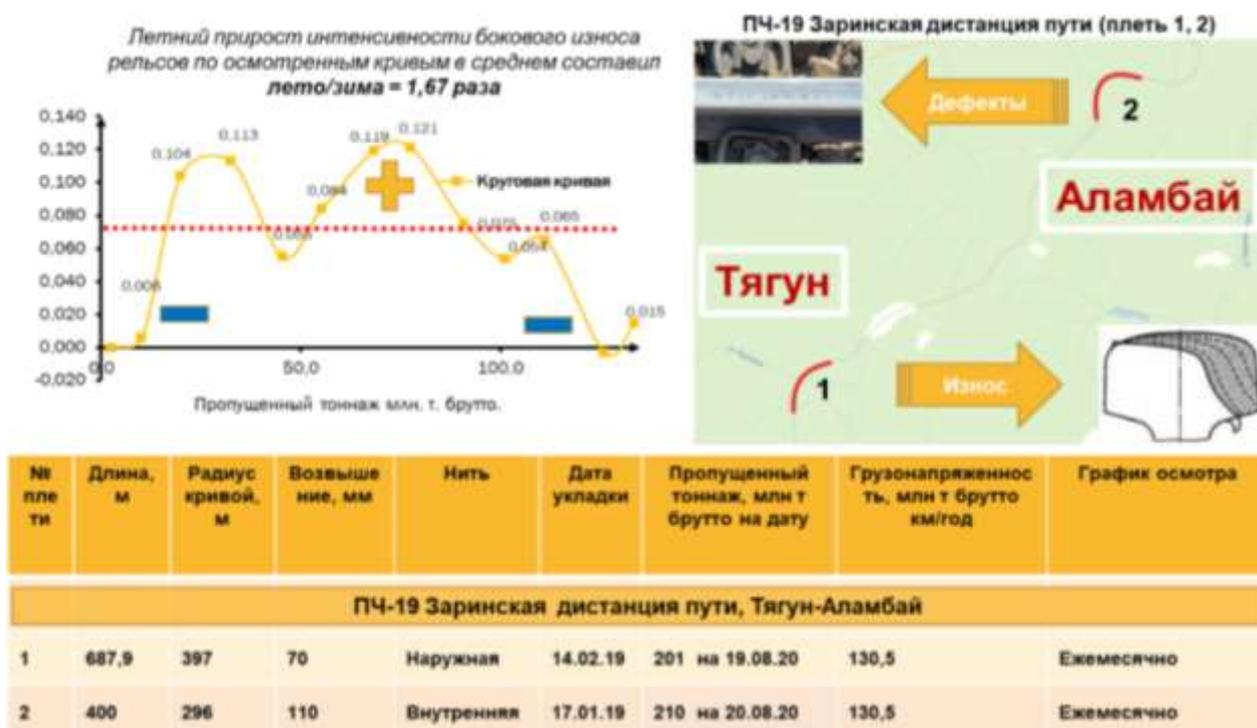
Рисунок 1.6 – Зависимость интенсивности износа рельсов ДТ350 в кривых малого радиуса при разных климатических условиях [17]
