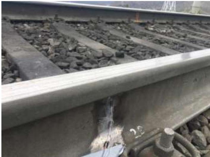
Рисунок 3.2 – Общий вид наклейки тензорезисторов на шейке рельса в измерительном сечении
