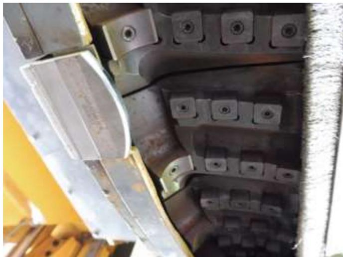
Рисунок 7.3 – Общий вид размещения кассет с твердосплавными пластинами на фрезерном колесе
