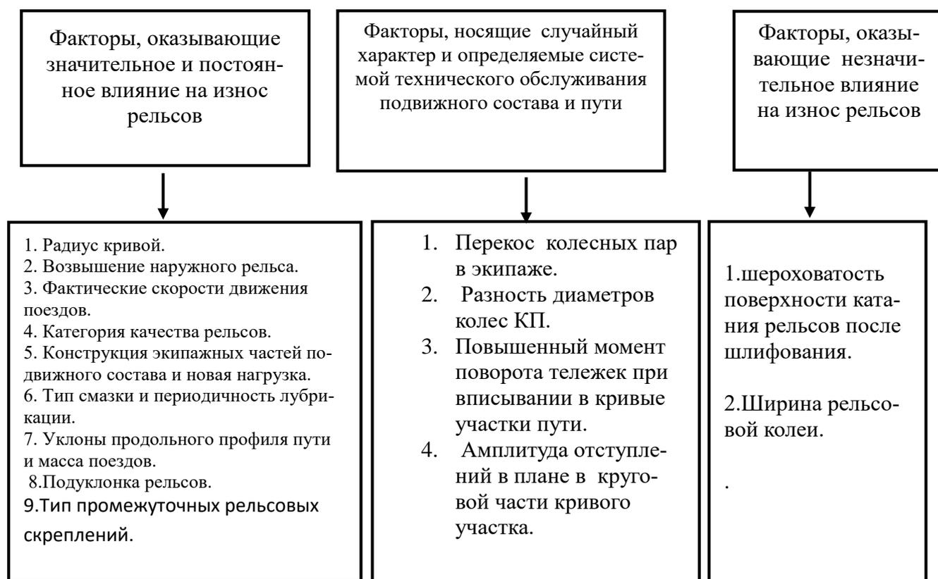
Рисунок 2.3 – Структура факторов, влияющих на износ рельсов
