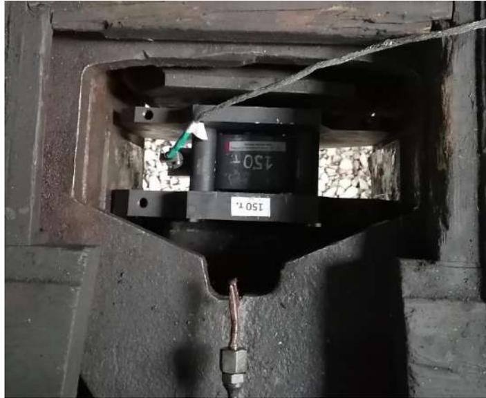
**Рисунок 2.18 – Установка динамометрической кассеты**
