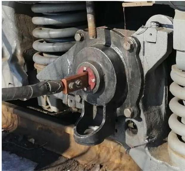
**Рисунок 2.9 – Букса с токоподводом**
