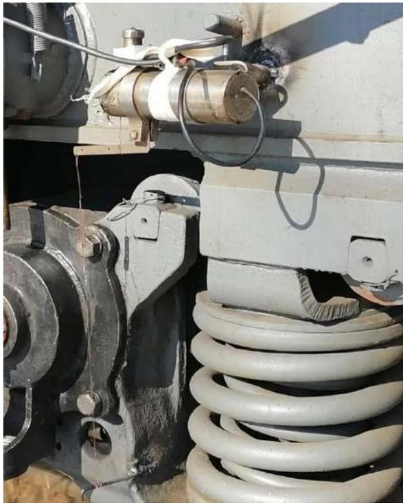
Рисунок 2.19 – Датчик перемещения
