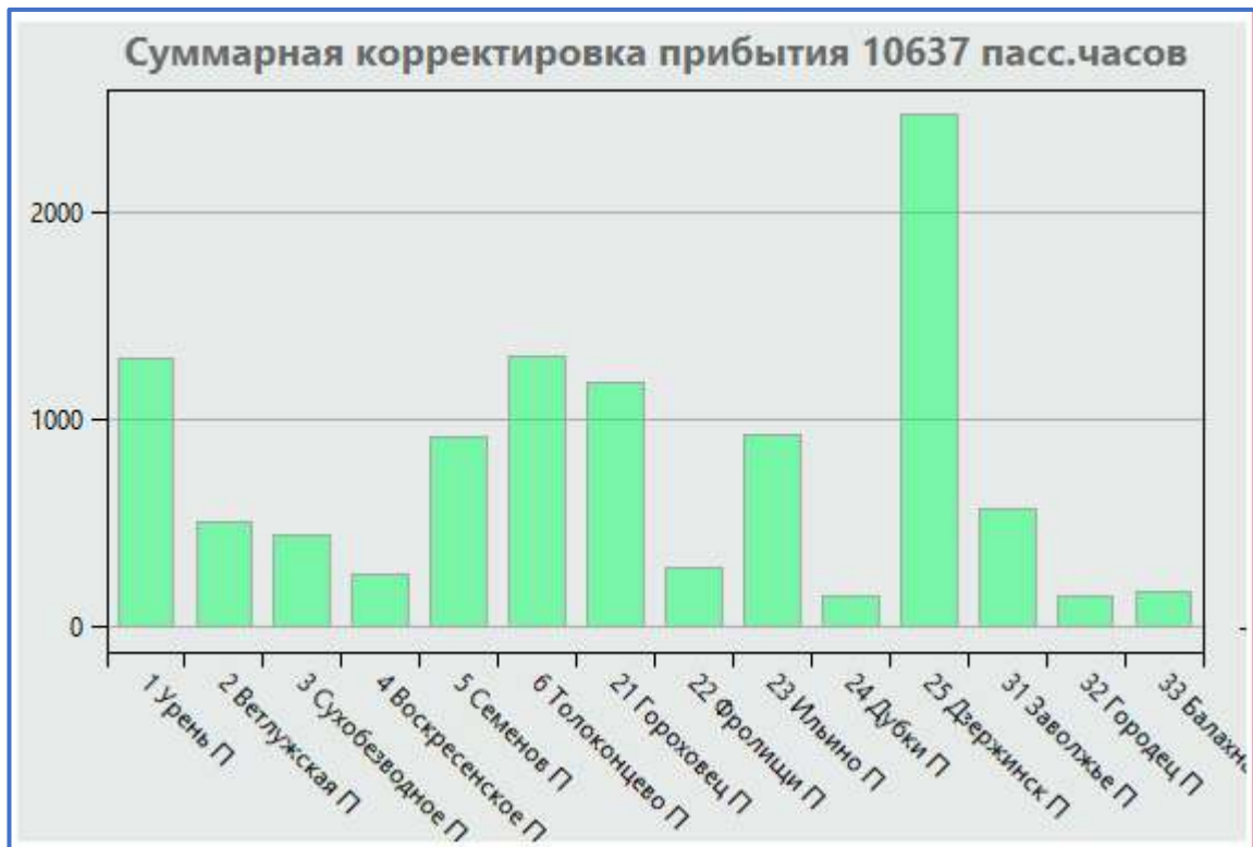
Рисунок 3.35 – Размеры корректировки подхода пассажиров на станции отправления
