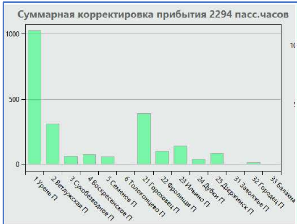
Рисунок 4.18 – Общая корректировка пассажиропотоков на станциях отправления
