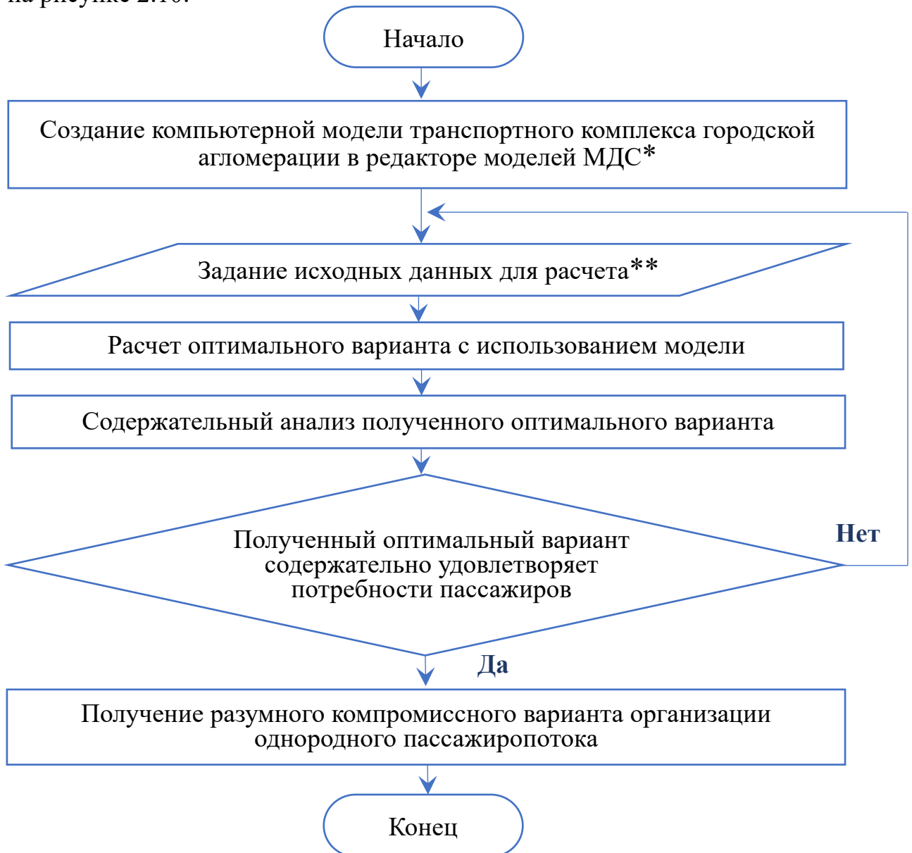
Рисунок 2.10 – Алгоритм поиска компромиссного оптимального варианта
