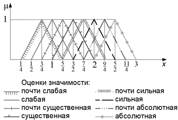
Рисунок 3 – Графическое изображение треугольных нечетких чисел оценок значимости объекта исследования
