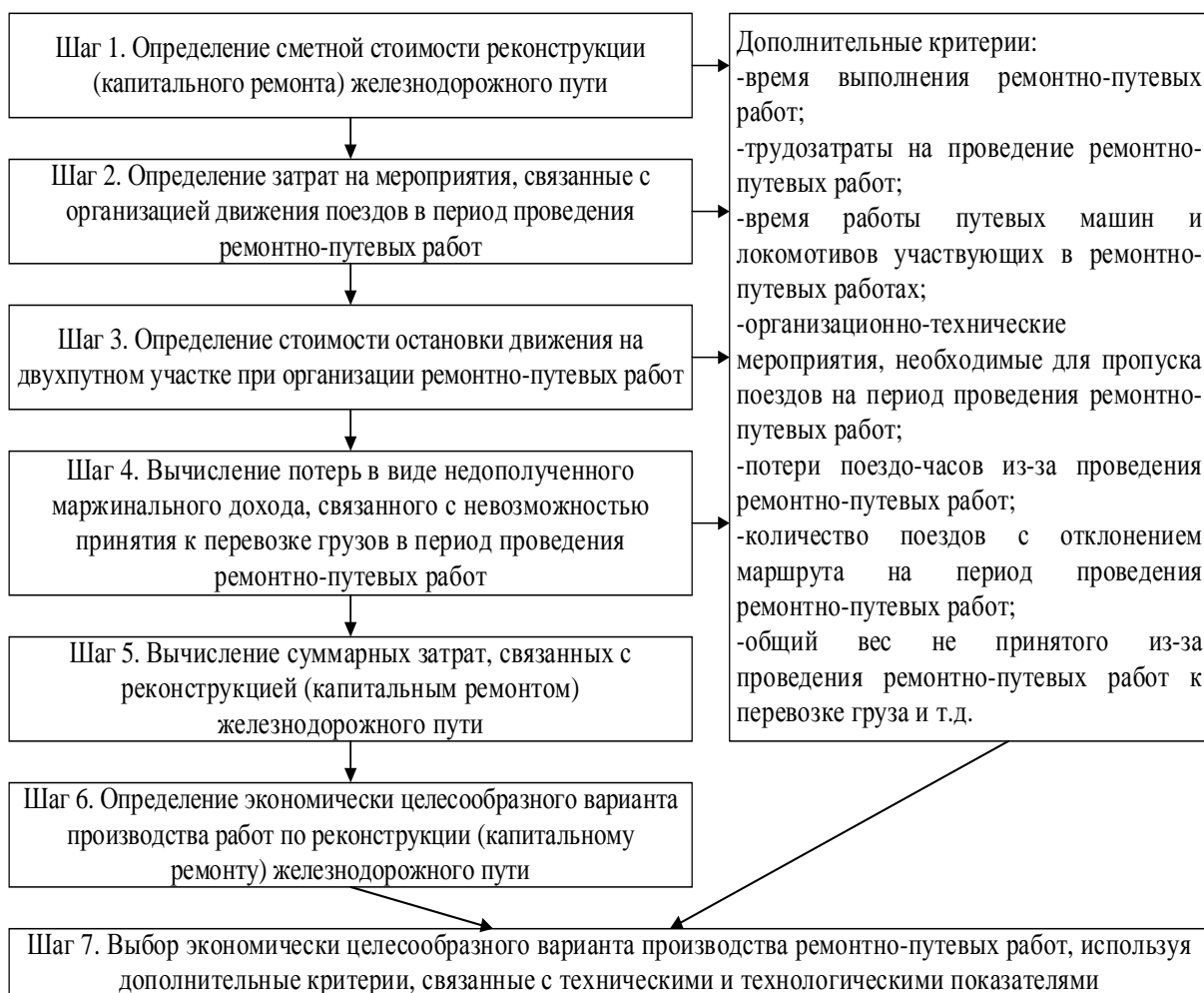
Рисунок 3 – Пошаговая модель расчета затрат на выполнение работ по реконструкции и капитальному ремонту железнодорожного пути
