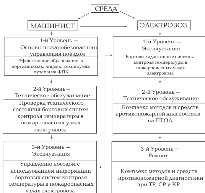
Рис. 1. Трёхэлементная и трёхуровневая система пожаробезопасного управления электровозом.
