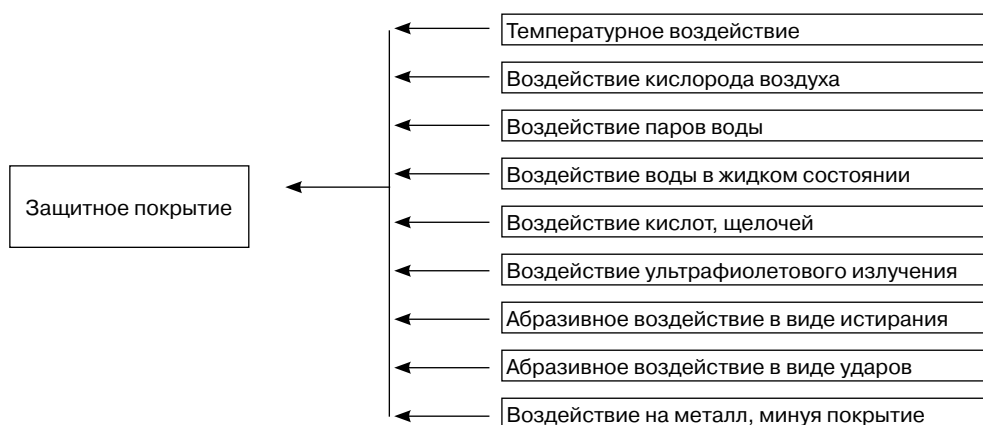
Рис. 3. Процессы и факторы воздействия агрессивной коррозионной среды.
