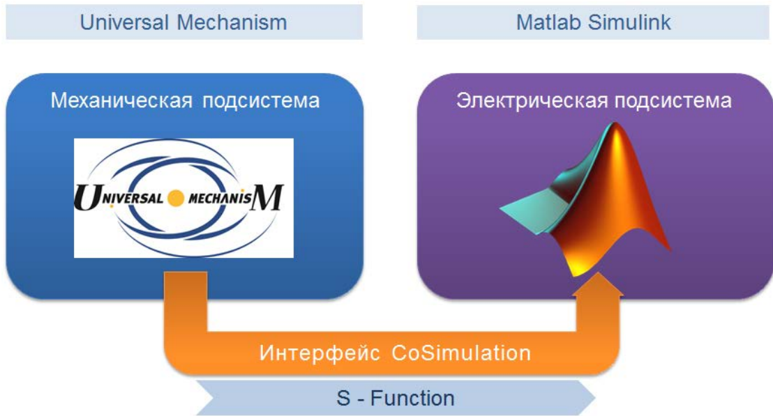
Рисунок 4.6. Совмещение подсистем электромеханической модели при помощи инструмента CoSimulation
