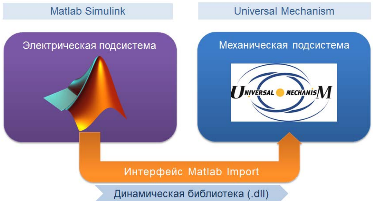
Рисунок 4.5. Совмещение подсистем электромеханической модели при помощи инструмента Matlab Import
