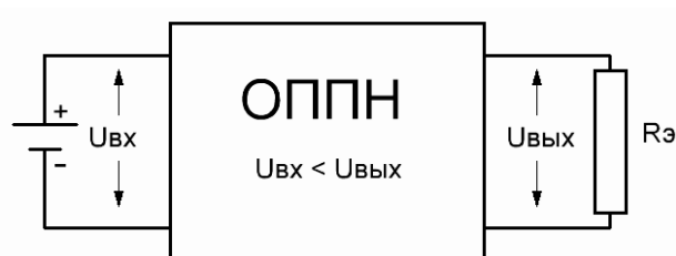
Рисунок 2.4 – Упрощенная функциональная схема ОППН с эквивалентной нагрузкой
