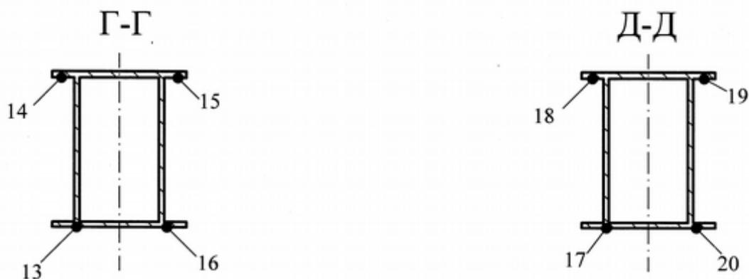
Рисунок 3.10 – Схема расположения контрольных точек на сечениях шкворневой балки рамы полувагона
