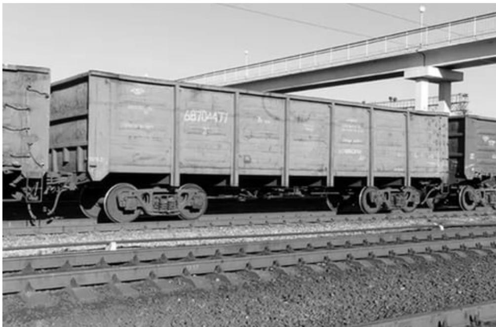
Рисунок 2.2 – Полувагон глухого типа модели 12-1592
