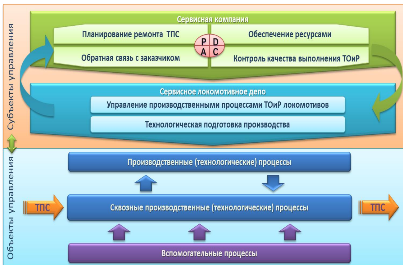
Рисунок 2.1 – Цикл PDCA при управлении техническим состоянием локомотивов
