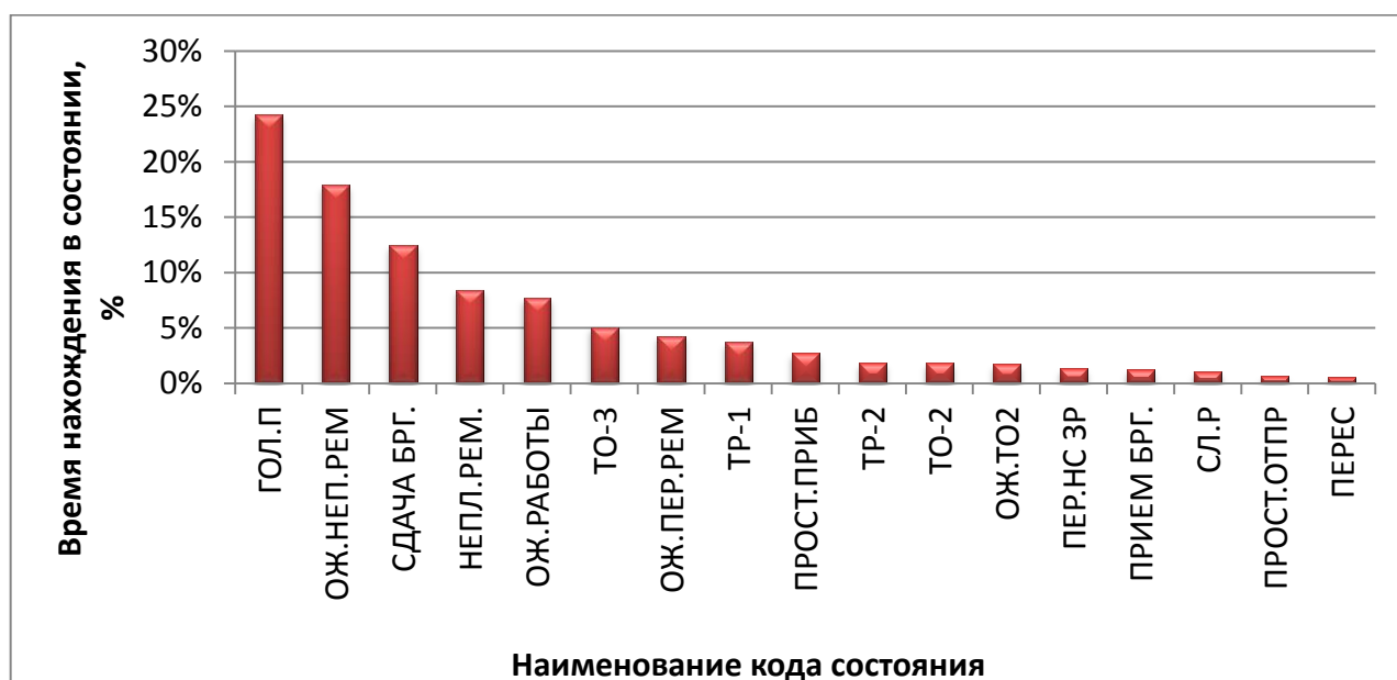
Рисунок 3.14 – Гистограмма распределения времени нахождения в различных состояниях (согласно классификатору информационной системы АСОУП) тепловозов серии ТЭП70в/и
