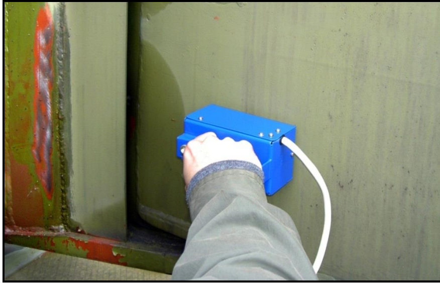
Рисунок 1.26 – Пример выполнения измерений H_C при проведении технического диагностирования вышки типа 40В6М с применением структуроскопа (коэрцитиметра) КРМ-Ц-К2М. Положение датчика КРМ-Ц-К2М на снимке – вдоль направления прокатки профиля листа
