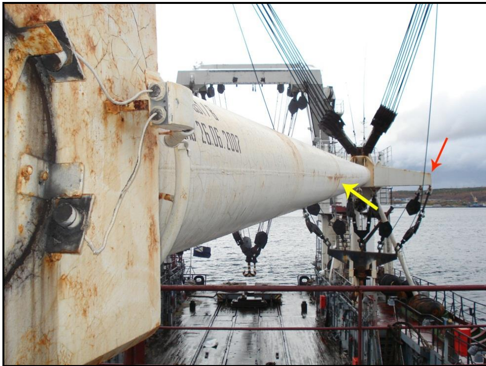
Рисунок 1.7 – Пример наличия локальных остаточных деформаций на стреле килектора (показано желтой стрелкой)
