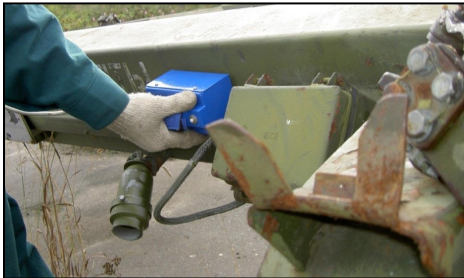
Рисунок 1.25 – Пример выполнения измерений H_C при проведении технического диагностирования вышки типа 40В6М с применением структуроскопа (коэрцитиметра) КРМ-Ц-К2М. Положение датчика КРМ-Ц-К2М на снимке – вдоль направления прокатки профиля листа
