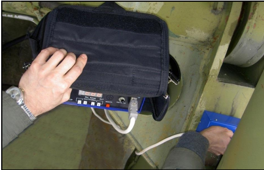
Рисунок 1.24 – Пример выполнения измерений H_C при проведении технического диагностирования вышки типа 40В6М с применением структуроскопа (коэрцитиметра) КРМ-Ц-К2М. Положение датчика КРМ-Ц-К2М на снимке – вдоль направления прокатки профиля листа
