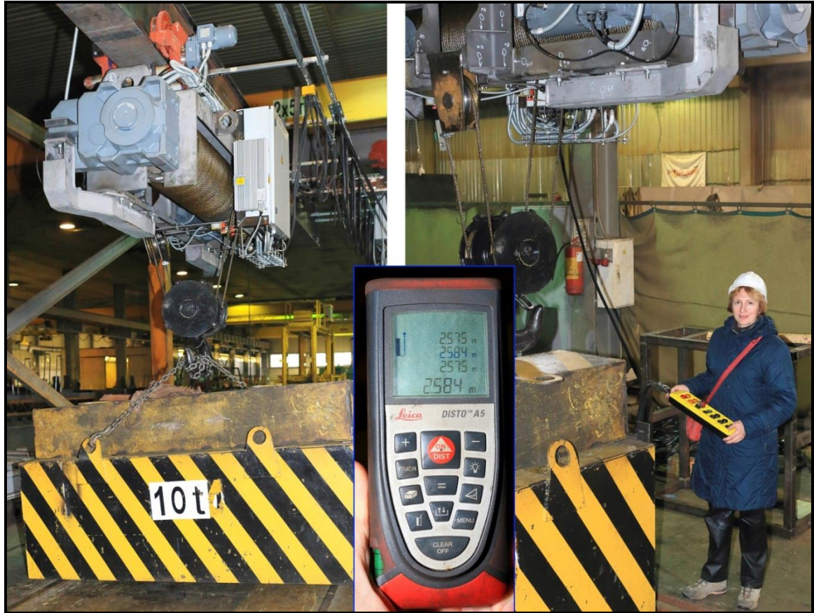
Рисунок 3.16 – Статические испытания крана мостового, специального, однобалочного, грузоподъемностью 10 т для ОИАЭ. Удержание краном поднятого груза 12,5 т
