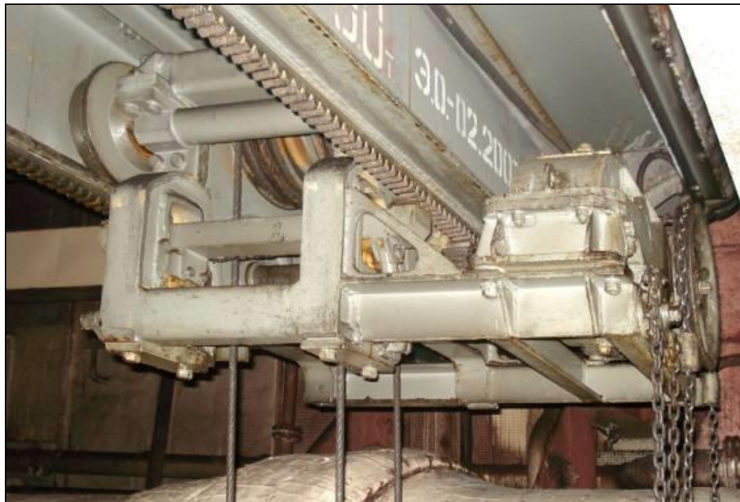
Рисунок 1.2 – Пример конструкции судового крана специального назначения
