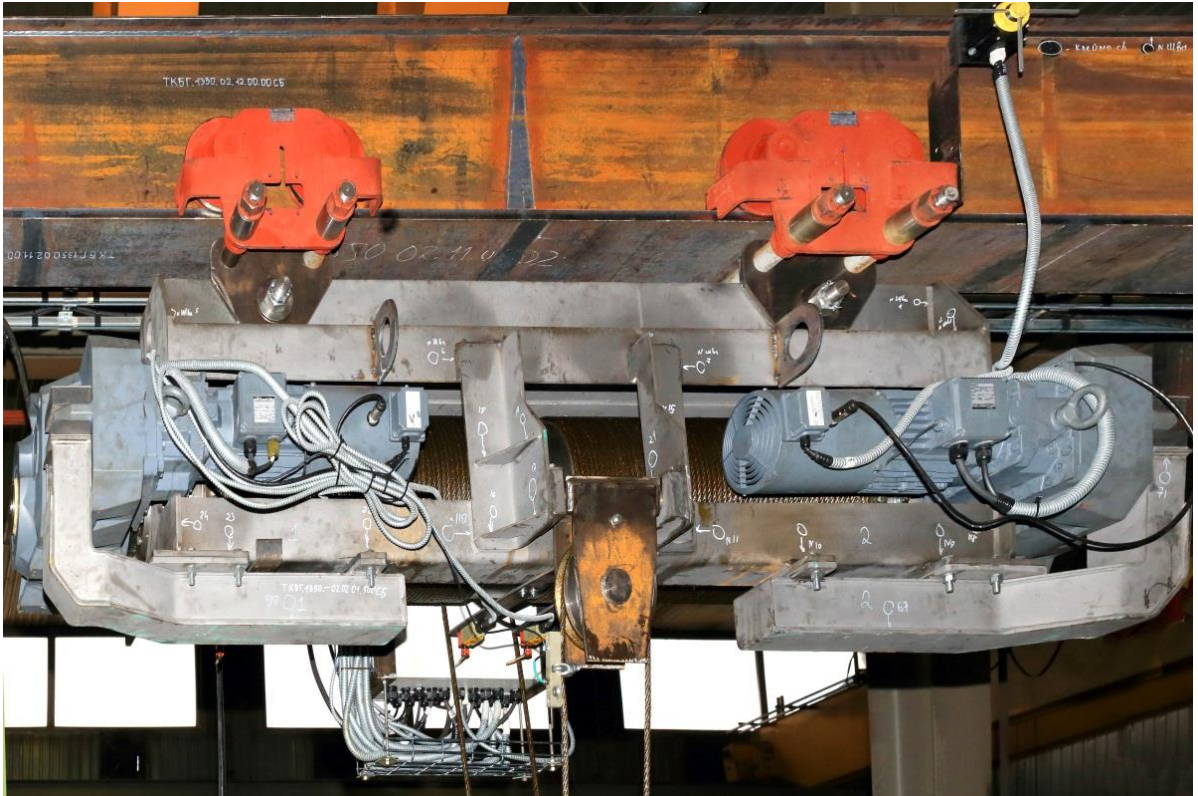
Рисунок 3.15 – Общий вид механизма подъема крана мостового, специального, однобалочного, грузоподъемностью 10 т для ОИАЭ. Механизм подъема крана собран, но еще не окрашен
