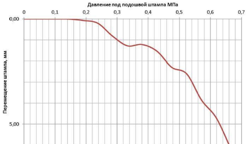
Рис.7.20. Кривая «нагрузка-осадка» по результатам испытания штампом материала щебеночной колонны после выполнения уплотнения на глубине 11 м
