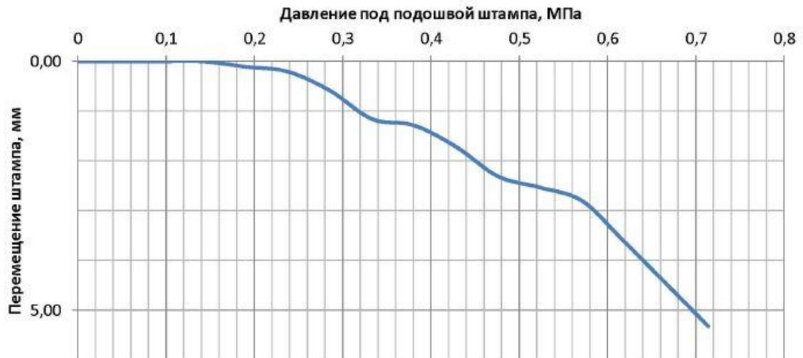
Рис.7.21. Кривая «нагрузка-осадка» по результатам испытания штампом материала щебеночной колонны после выполнения уплотнения на глубине 12 м
