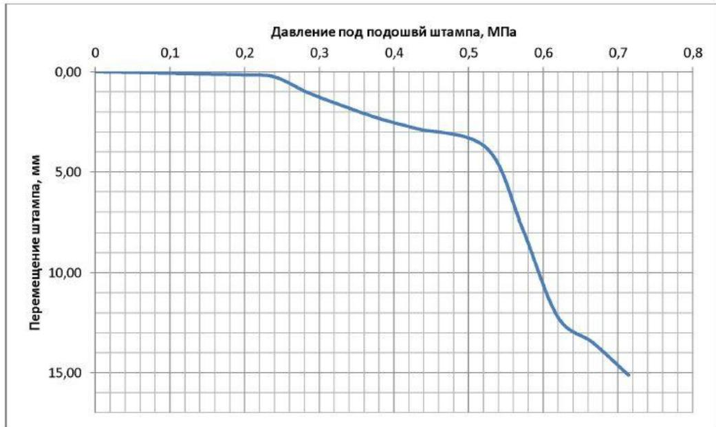
Рис.7.19. Кривая «нагрузка-осадка» по результатам испытания штампом грунта после уплотнения щебеночными колоннами на глубине 10 м
