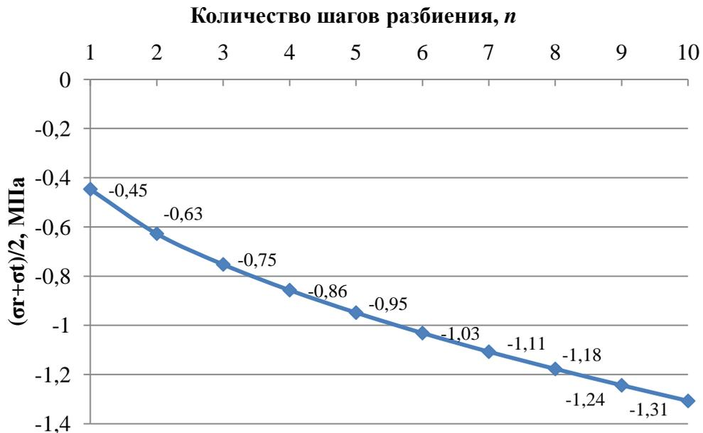
Рис.5.10. График зависимости  $\sigma_m=f(n)$  согласно (5.20)
