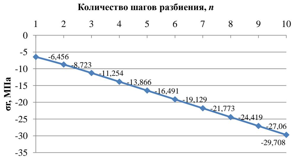
Рис.5.7. График зависимости  $\sigma_r=f(n)$  при возрастании  $E_i = E_0 \cdot i$
