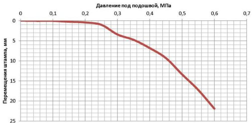
Рис.7.17. Кривая «нагрузка-осадка» по результатам испытания штампом слабого грунта в естественном состоянии на глубине 6 м
