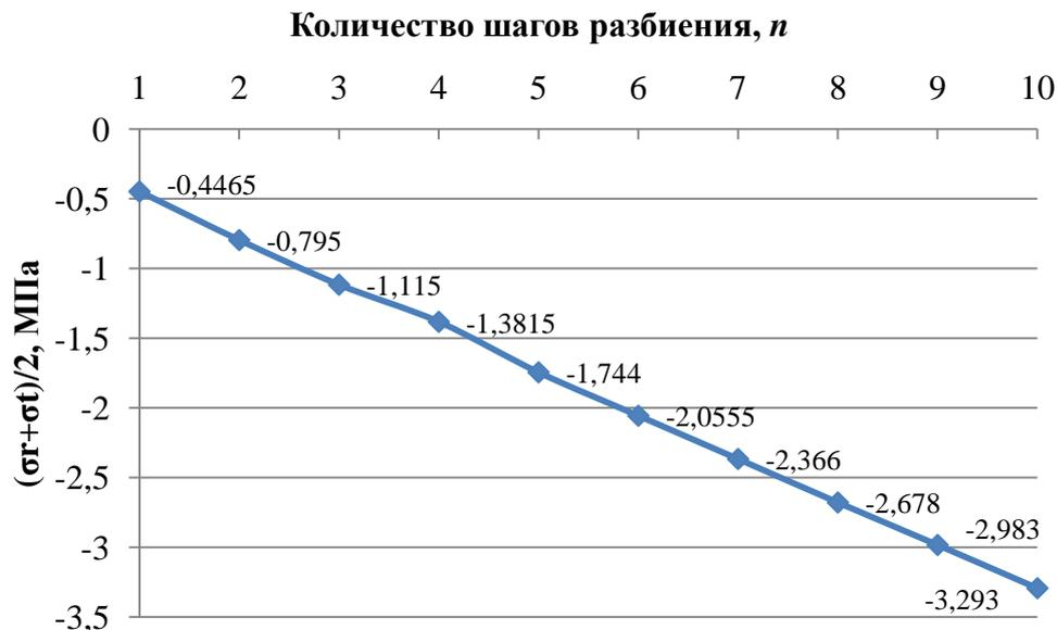
Рис.5.8. График зависимости  $\sigma_m=f(n)$  при возрастании  $E_i = E_0 \cdot i$
