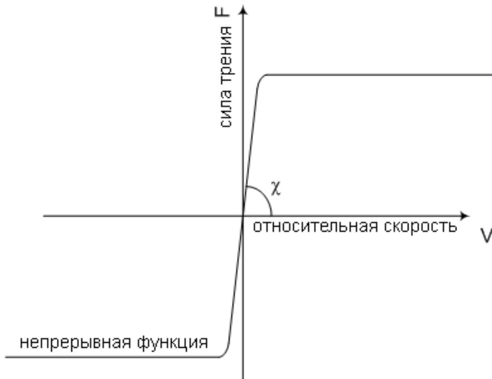
Рис. 3. График функции силы трения скольжения
