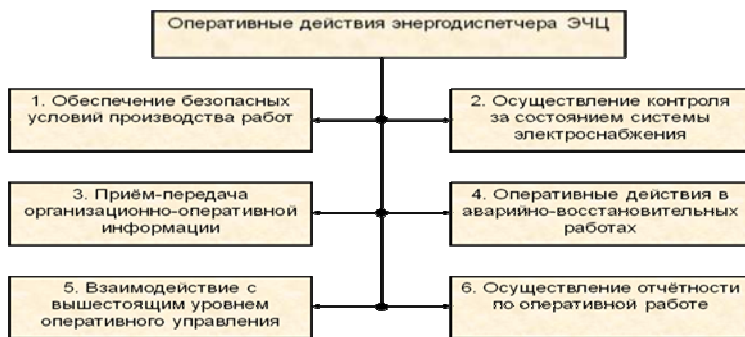
Рис.1 – Классификация оперативных действий энергодиспетчера дистанции электроснабжения.
