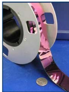
Рис. 1 – Структура ВТСП проводника второго поколения и его внешний вид
