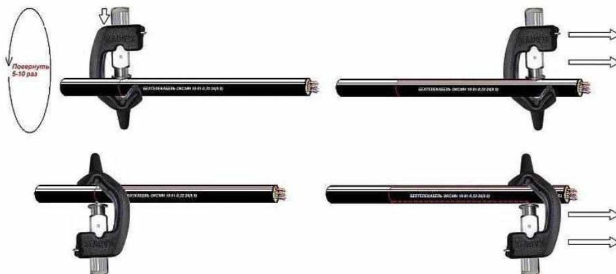
Рисунок 6 – Снятие внешней оболочки кабеля ножом-стриппером
