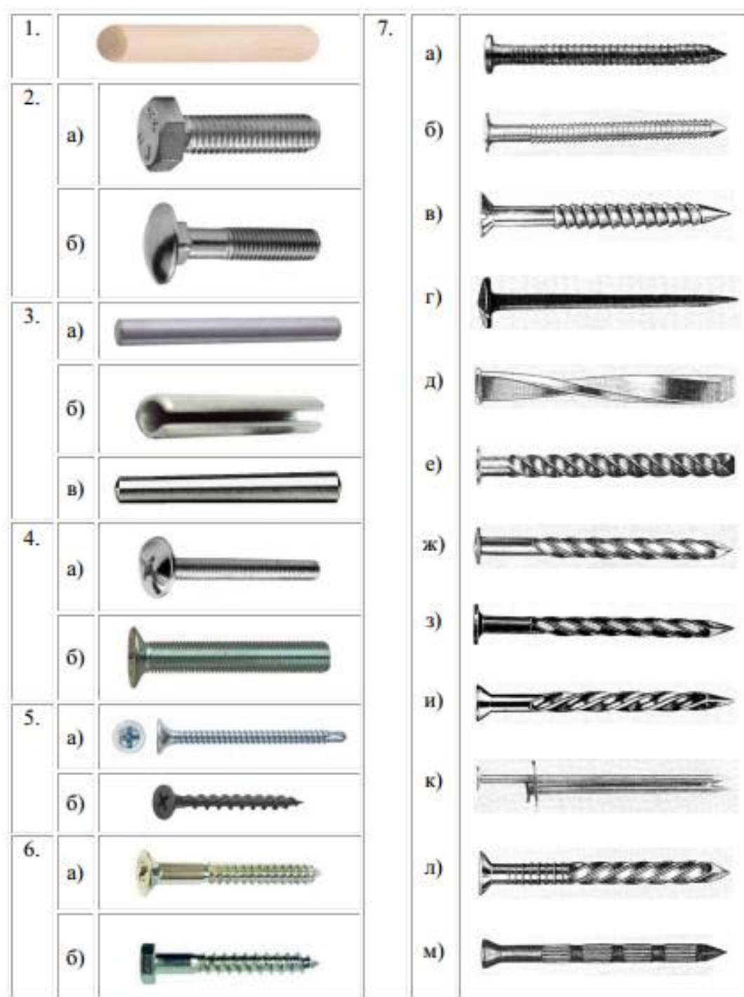
Рисунок 1.1 – Основные виды нагелей, используемые в соединениях конструкций из древесины (1 – дубовый нагель, 2 – болты, 3 – штифты, 4 – винты, 5 – самонарезающие шурупы, 6 – обыкновенные шурупы, 7 – гвозди)
