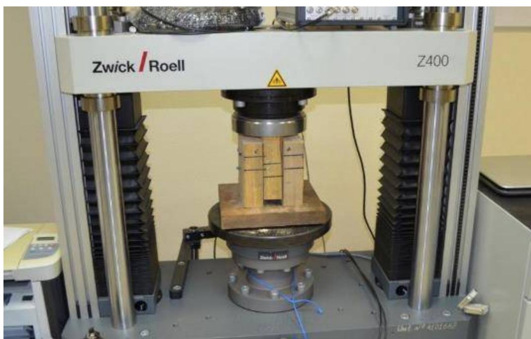
Рисунок 3.12 – Образец в испытательной машине Zwick Z400E
