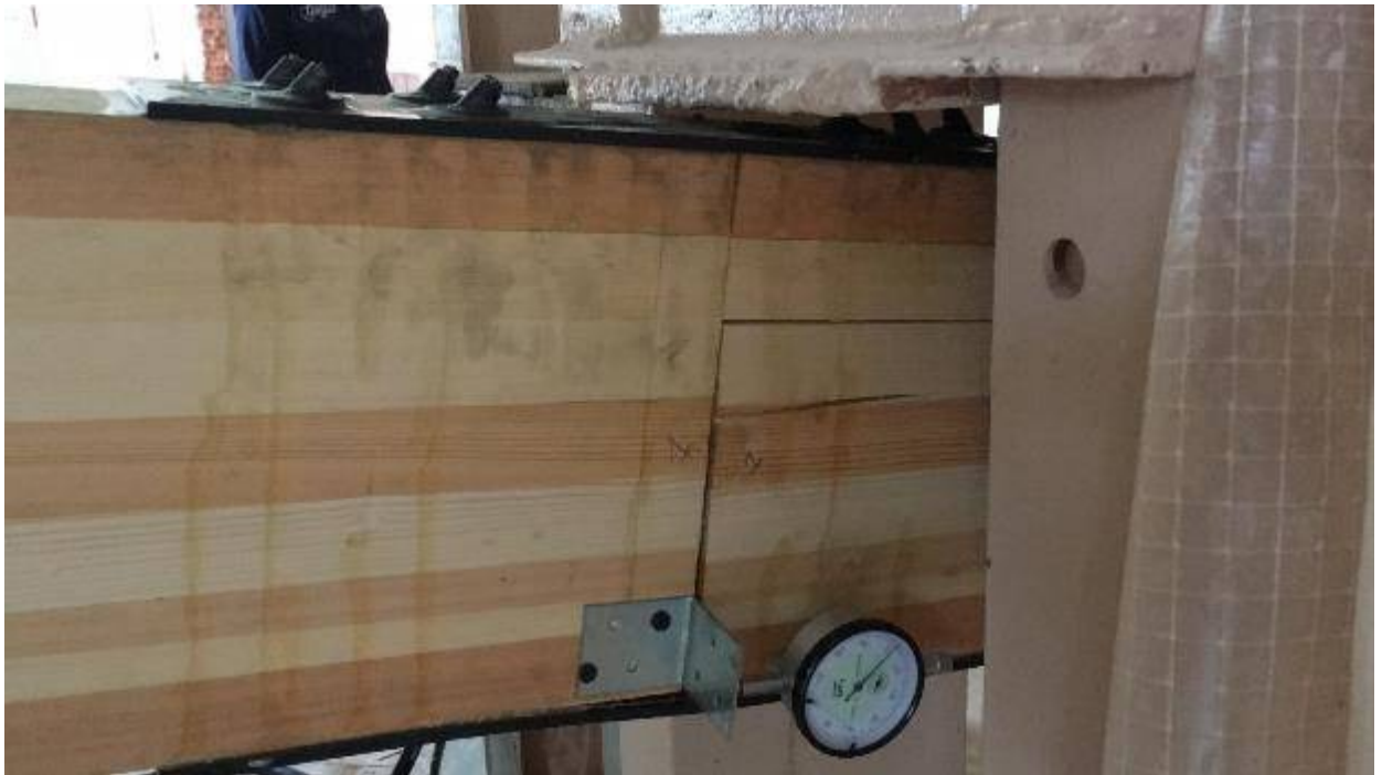
Рисунок 4.27 – Разрушение стыка, образование продольных трещин
