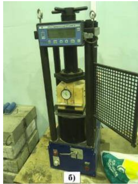
Рисунок 3.6 – Образцы в прессе ПГМ-500МГ с установленными индикаторами ИЧ-10
