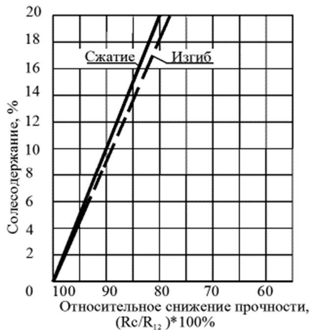
Рисунок 2.8 – Снижение относительной прочности древесины в зависимости от содержания соли
