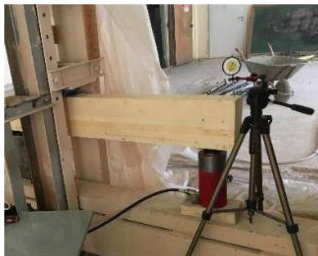
Рисунок 4.26 – Балки со стыком и без стыка на испытательном стенде
