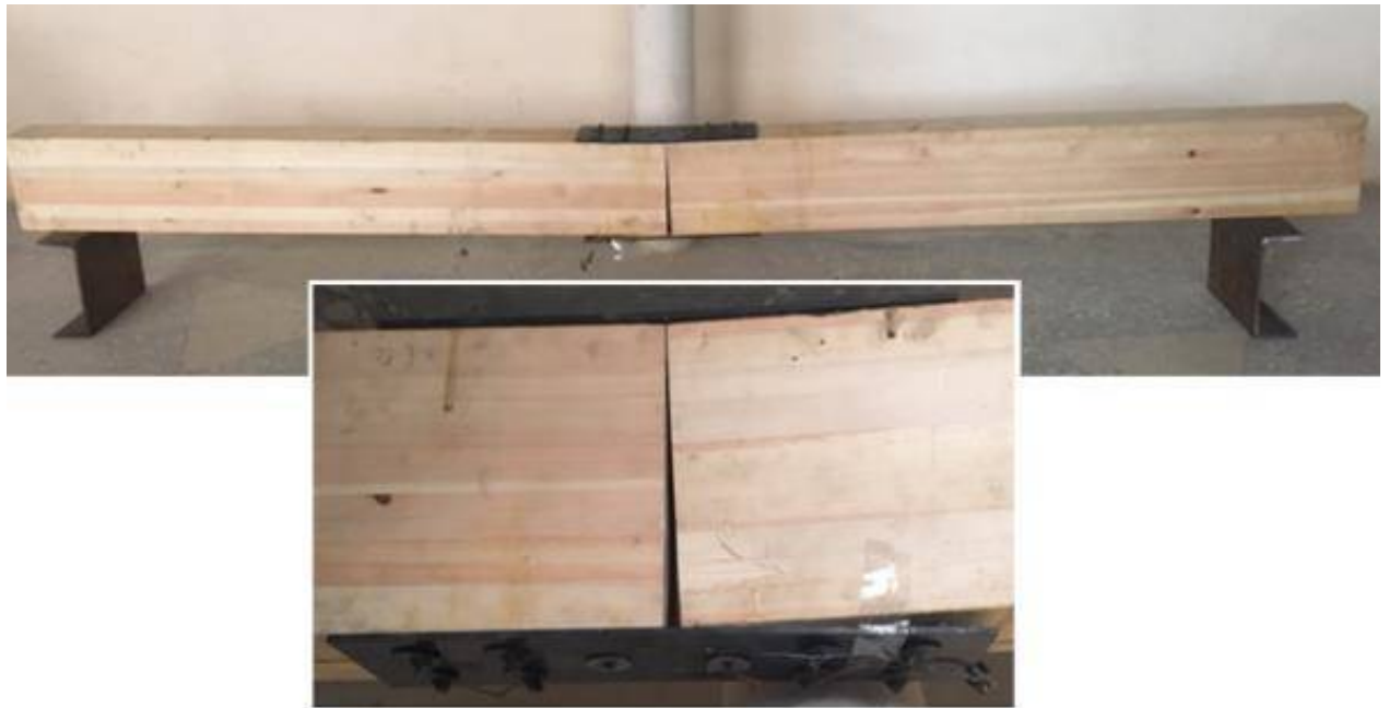
Рисунок 4.17 – Образец после разрушения стыка
