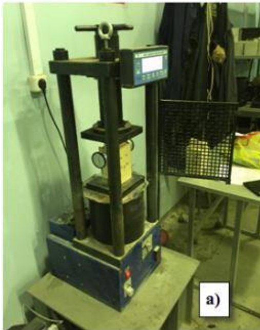
Рисунок 3.6 – Образцы в прессе ПГМ-500МГ с установленными индикаторами ИЧ-10
