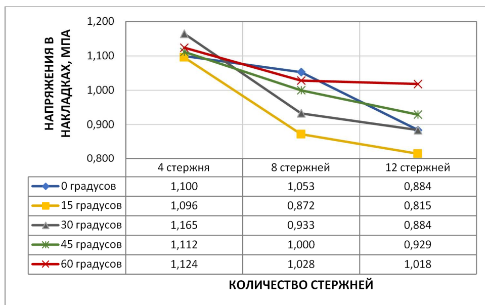
Рисунок 4.7 – График зависимости максимальных напряжений в накладках от угла вклейки и количества нагелей
