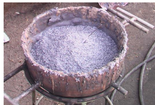
Рисунок Д–5 – Тигель с засыпанной термитной смесью и со спичкой
