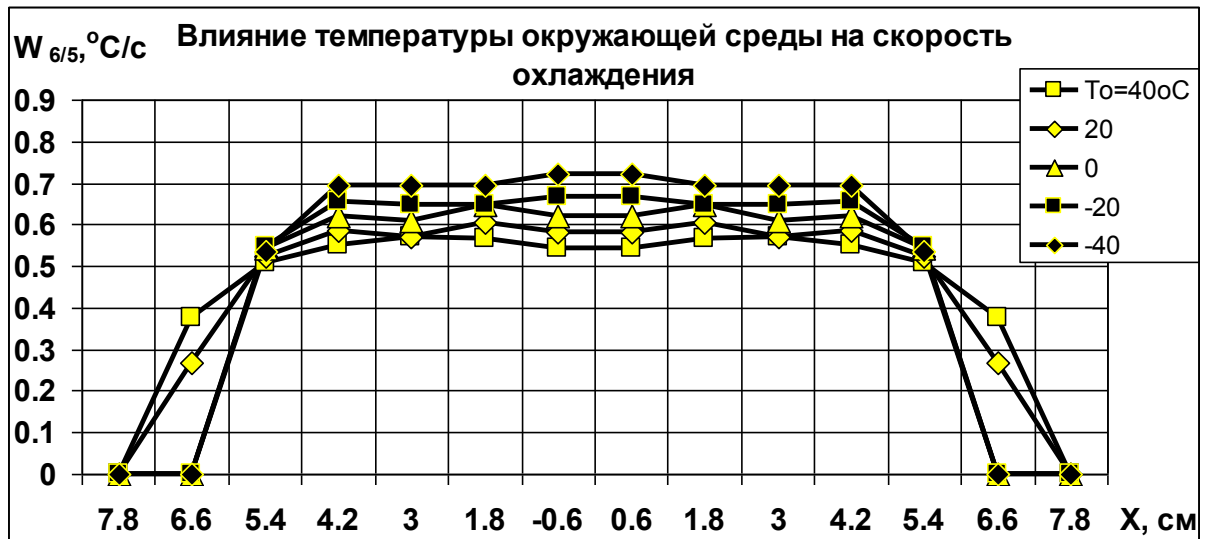
Рисунок 71 – Влияние температуры окружающей среды на скорость охлаждения
