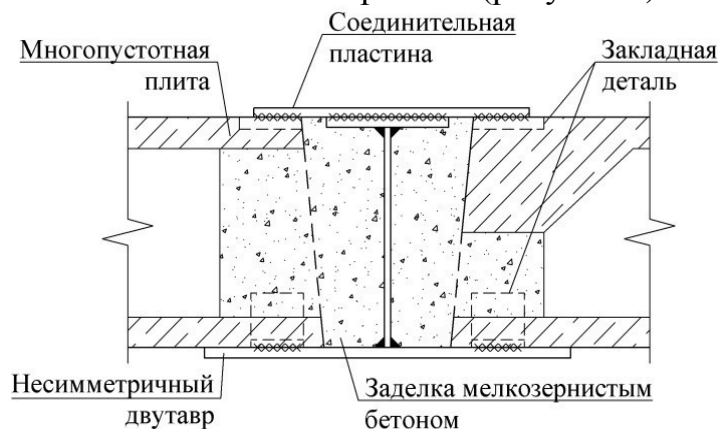
Рисунок 4 – Схема опирания многopустотных плит на нижнюю полку несимметричного двутавра
